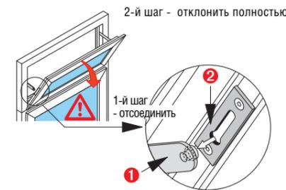
Чтобы полностью отклонить откидную створку (положение для мойки), необходимо отсоединить боковые складные ножницы.
