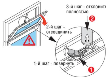
Чтобы полностью отклонить откидную створку (положение для мойки), необходимо отсоединить фурнитуру для фрамуг.
