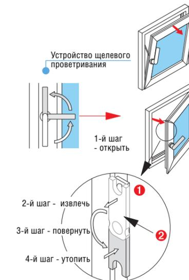
Скрытое устройство щелевого проветривания (1) ограничивает поворотное и откидное положение створки в положении для проветривания.
