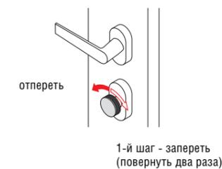
Этот замочный цилиндр приводится в действие снаружи ключом, а изнутри - поворотной кнопкой.
