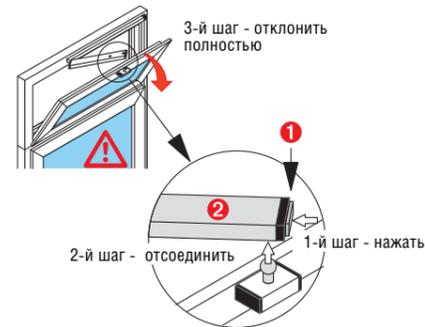
Чтобы полностью отклонить откидную створку (положение для мойки), необходимо отсоединить фурнитуру для фрамуг.
