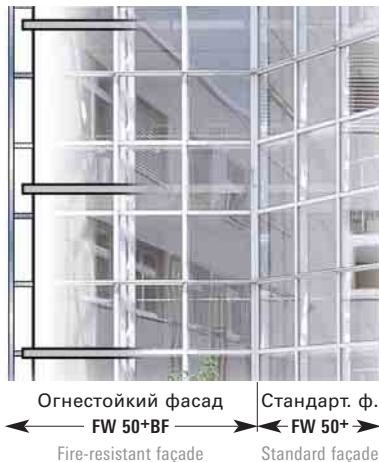
Переход от светопрозрачной крыши к вертикальному фасаду Transition from skylight to vertical façade
