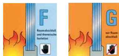
Различают два типа огнестойкого стекла: EI и E. There are two different types of fire-resistant glass: F and G
