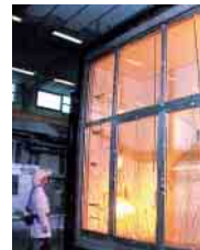
Испытания огнестойких элементов Schüco в центре испытания материалов Testing Schüco fire units at the Office for Materials Testing
