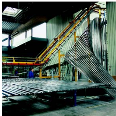
Установка профилей для вертикальной покраски
