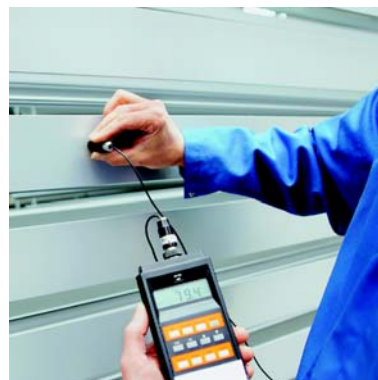
Проверка толщины слоя покрытия на окрашиваемых профилях
